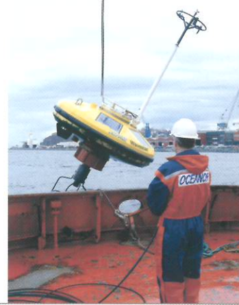
La boya para análisis de parámetros ambientales oceánicos se realiza en Trondheim © Company Fugro Oceanor
